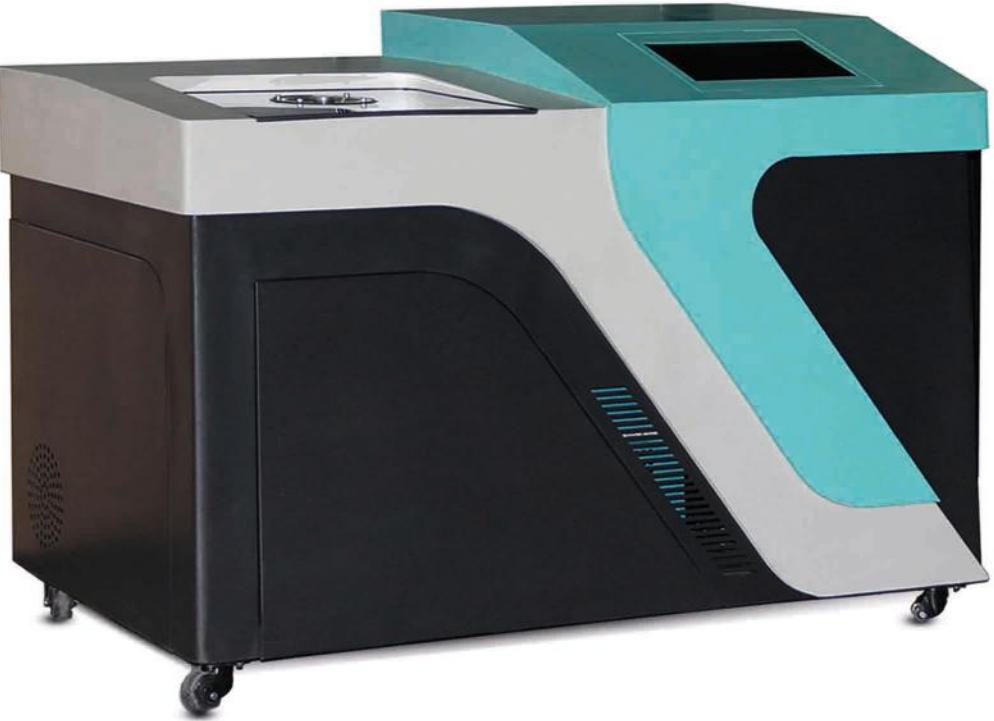
به دلیل استفاده از قطعات استیل و تیتانیوم با زبری حداقل و استفاده از الکتروپولیش در مرحله پایانی تولید آن قطعات، می‌توان از این سیستم در فرآیندهای تولید مبتنی بر GMP استفاده نمود. مجموعه روتور می‌تواند تا ۲/۵ لیتر مایع را درون خود جا داده و با اعمال دوران ۴۰۰۰ دور بر دقیقه‌ای و نیروی گرانشی ۱۰۰۰۰ g گستره وسیعی از مواد را به کمک آن جدا نمود.
